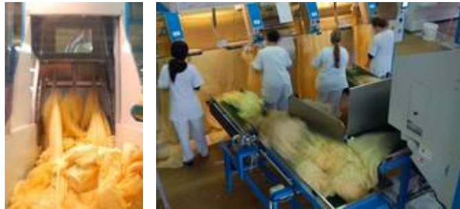
Viking Vereinzeler mit 3 Greifarmen. Wäschezuführung vom Vereinzeler zur Eingabemaschine.
