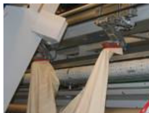
Schritt 4: Schnell und doch sanftes Spreizen des Wäschestückes auf den Vakuumbalken.
