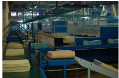
Automatischer Wäschetransfer vom Finishbereich zur Auslieferung.
