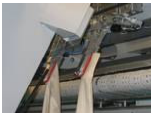
Schritt 2: Übergabe von den Eingabeklammern in die «Soft-Touch» Spreizklammern.
