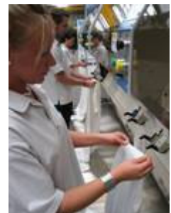
Schritt 1: Die 2 Ecken der Wäsche-frontkante werden in die höhenverstellbaren Eingabeklammern geklemmt.
