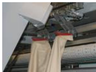
Schritt 3: Die «Soft-Touch» Spreizklammern bewegen sich in die horizontale Position.
